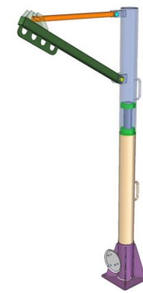
Der HG-500 AK dient zum Herausheben und Absenken von Pumpen in Pumpschächte mit Dömen bzw. großen Schachtöffnungen.
