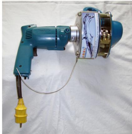
Der KZA 500 (5150, 5185) dient zum Herausheben und Absenken von Pumpen in Pumpschächte (bis max. 500 kg).
